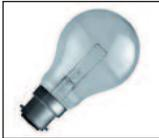
ampolleta) es un dispositivo que produce luz mediante el calentamiento por efecto Joule de un filamento metálico, en concreto de tungsteno, hasta ponerlo al rojo blanco, mediante el paso de corriente eléctrica. Con la tecnología existente, actualmente se considera poco eficiente, ya que el 80 % de la electricidad que consume la transforma en calor y solo el 20 % restante en luz. Son económicas, tienen poca vida útil, proporcionan luz cálida.
